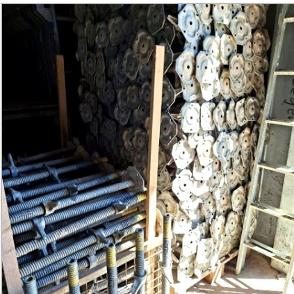
Nr. 175 · Fußspindeln und Fußplatten
